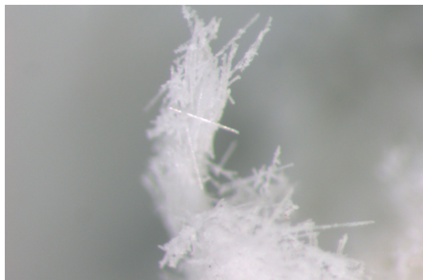
Glührückstand der Vergussmasse
