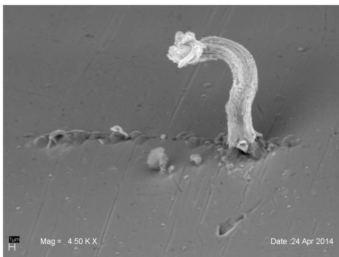
REM-Aufnahme: Wellenoberfläche im Detail, chloridhaltiges Korrosionsprodukt im Bereich einer Mangansulfid-Zeile
