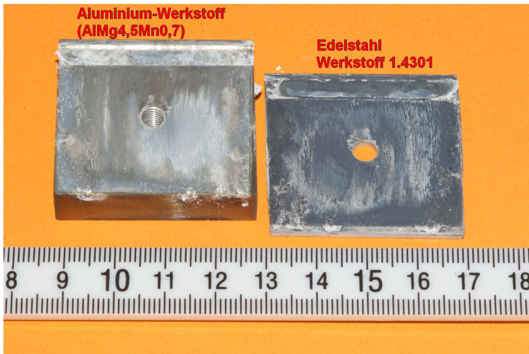
Abb. 2: Bauteile nach der Feuchtelagerung
